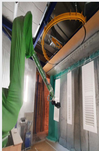
3 COUCHES DE FINITION après un égrenage manuel
