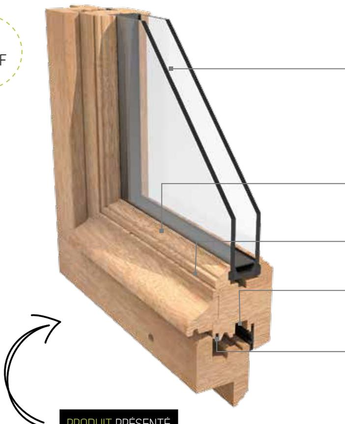
Double ou triple vitrage de 28 mm à 38 mm à isolation renforcée par une couche de faible émissivité et du gaz argon, intercalaire Warm Edge
