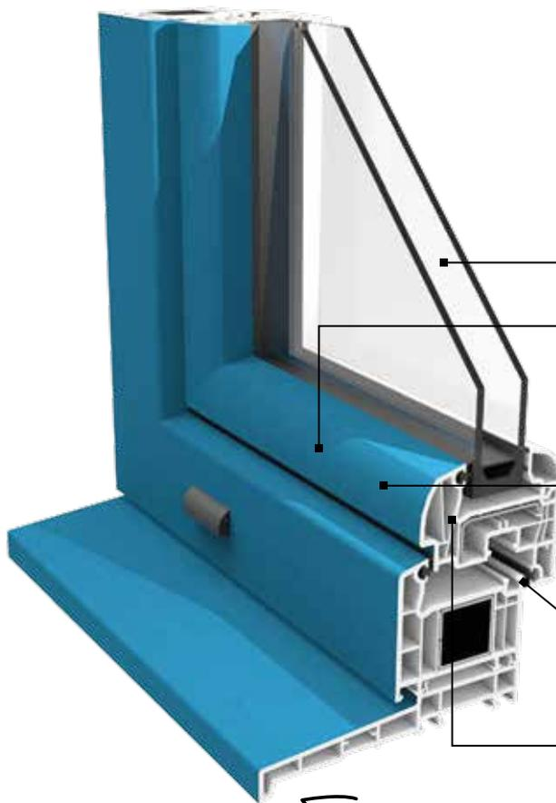
Double ou triple vitrages de 28 à 40 mm à isolation thermique renforcée par une couche de faible émissivité et du gaz argon, intercalaire Warm Edge noir.
