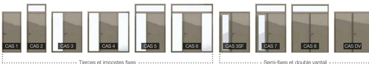
Les modèles Spencer et Franklin peuvent être associés à des parties latérales fixes ou semi-fixes de mêmes design : Spencerside et Franklinside. Le modèle Spencer est également disponible avec des impostes moulurées munies de la grille Alva. Disponibilité des modèles semi-fixes et double vantail pour PASSAGE uniquement.
